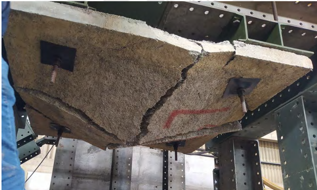
Figura 2-9. Interrupción de un ensayo por colapso prematuro de la muestra.
