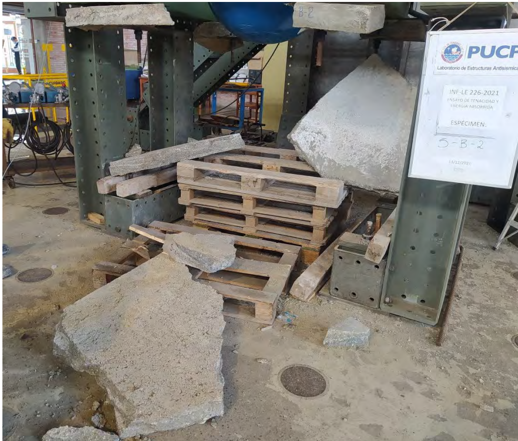
Figura 2-9. Interrupción de un ensayo por colapso prematuro de la muestra.
