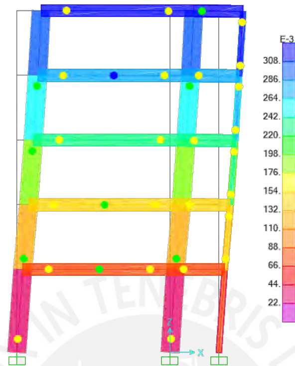
Figura B. 11: Modelo estructural con deformaciones máximas (m) ocasionadas por una señal sintética con PGA igual a 0.60g.
