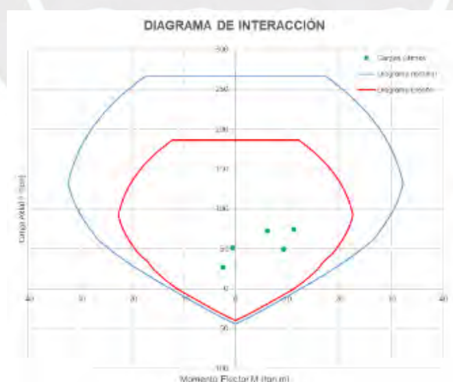
Figura 6.18: Diagrama de interacción de columna C5 para análisis por Método de Rigidez Sistematizado
