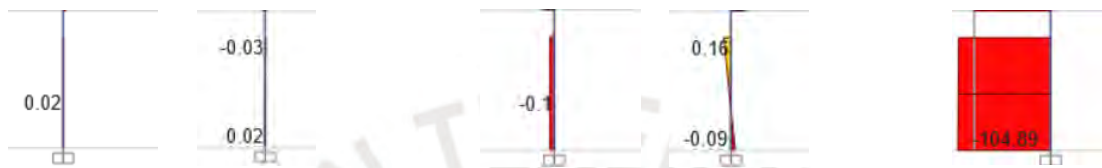
Figura 5.54: DFC22, DMF33, DFC33, DMF22 y DFN respectivamente de columna C5 en pórtico B por carga muerta
