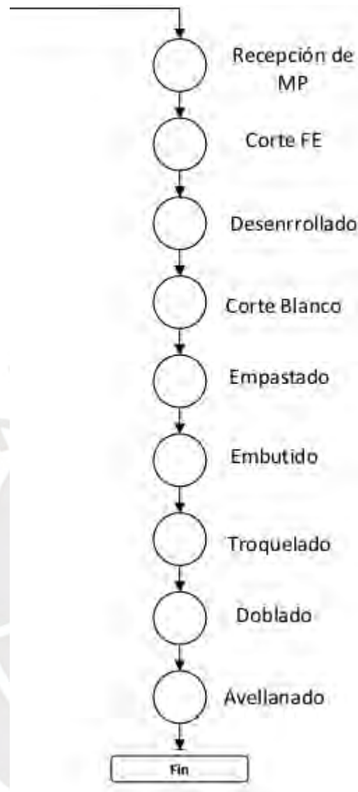
Figura 57. Diagrama de Operaciones de proceso del prensado de Canastilla C-240.
