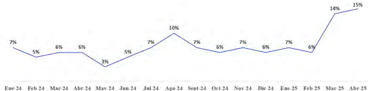
Figura 26. Porcentaje de observados de ensamble de cerraduras (100 % X Unidades observadas / Unidades producidas) . Perdido 2024-2025.
