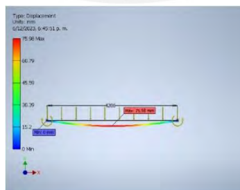
Figura 83: Simulación de deflexión por carga distribuida y \Delta T Autodesk Inventor
