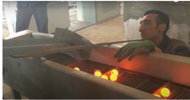
Figura 11: Transportador de Malla Tomado de “ Transportador de malla ” ANYANG FORGING PRESS MACHINERY INDUSTRY, (s.f.)
