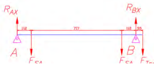
Figura 64: Esquema de fuerzas plano XZ
