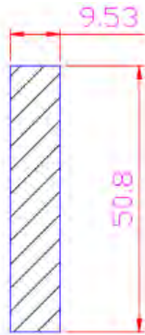
Figura 75: Perfil o sección de la platina base
