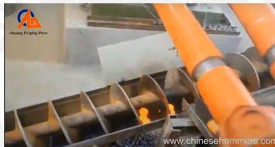
Figura 9: Transportador helicoidal de bolas Tomado de “ Transportador de tornillo ” ANYANG FORGING PRESS MACHINERY INDUSTRY, (s.f.)
