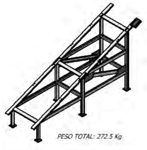
Figura 94: Estructura inferior con 3 apoyos (vigas U)
