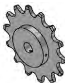
Figura 42: Modelamiento de sprocket de arrastre
