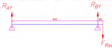
Figura 63: Esquema de fuerzas plano YZ
