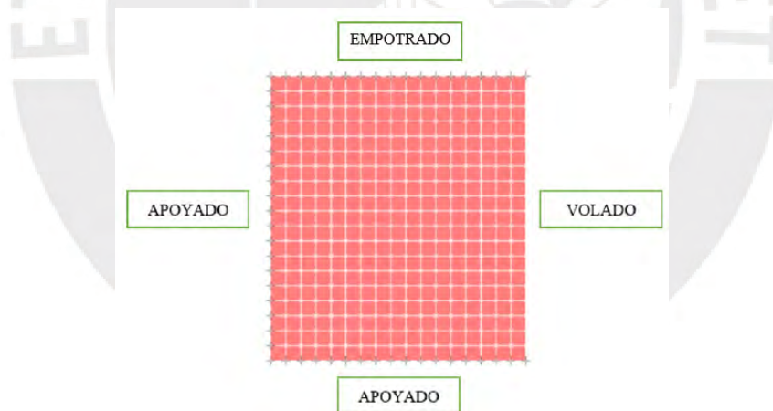
Figura 7.9: Modelo de losa maciza (eje F-G/1-3).
