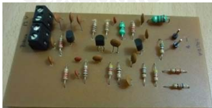
Figura 3.3: Tarjeta del circuito oscilador Fuente: Elaboración Propia
