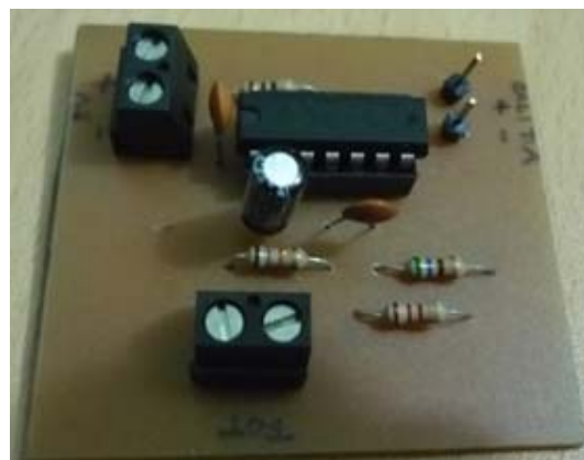
Figura 3.6: Tarjeta del circuito de modo pulsado
