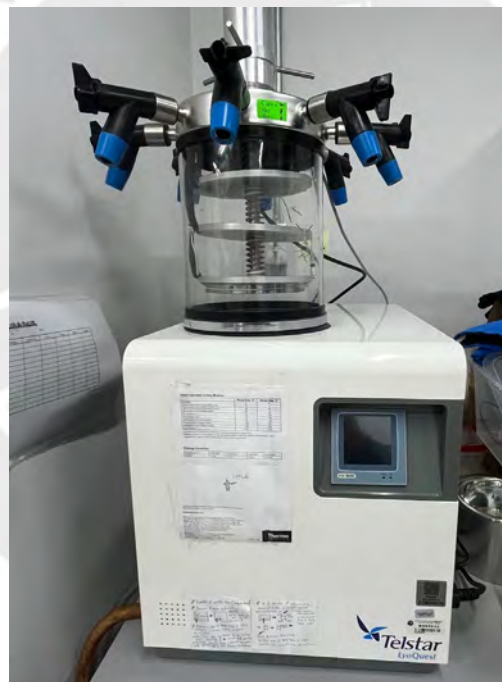
Figura 23. Proceso de liofilización de muestras A3G4SG5 y A3G4 con liofilizador Telstar
