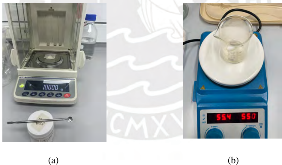
Figura 7. Proceso de preparación de hidrogeles de alginato y gelatina. (a) Medición del peso de la gelatina y alginato en polvo. (b) Agitación con agua milliq de la gelatina y el alginato
