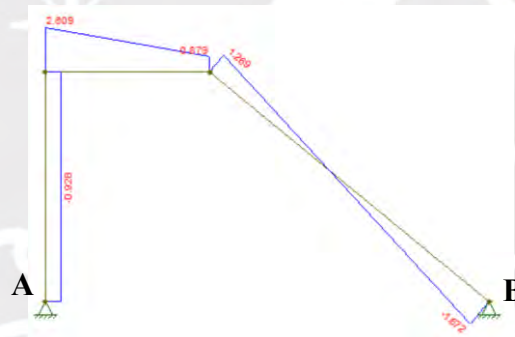
Figura 91 Diagrama de fuerza cortante (DFC) de tramo 1 del primer piso.
