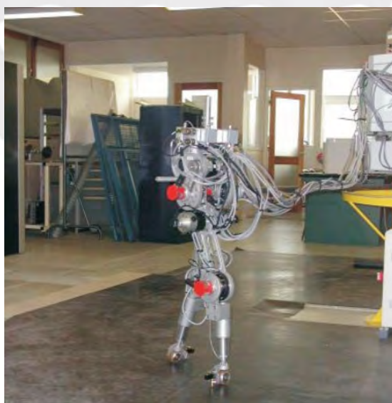
Figura 1.32. Prototipo del robot bípedo antropomórfico [Miossec, 2004]
