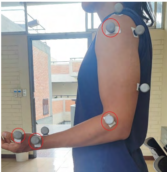
Figura 4.5 Marcadores ubicados en el participante en el plano frontal sagital. Los marcadores específicos del plano se encuentran dentro de los círculos rojos.
