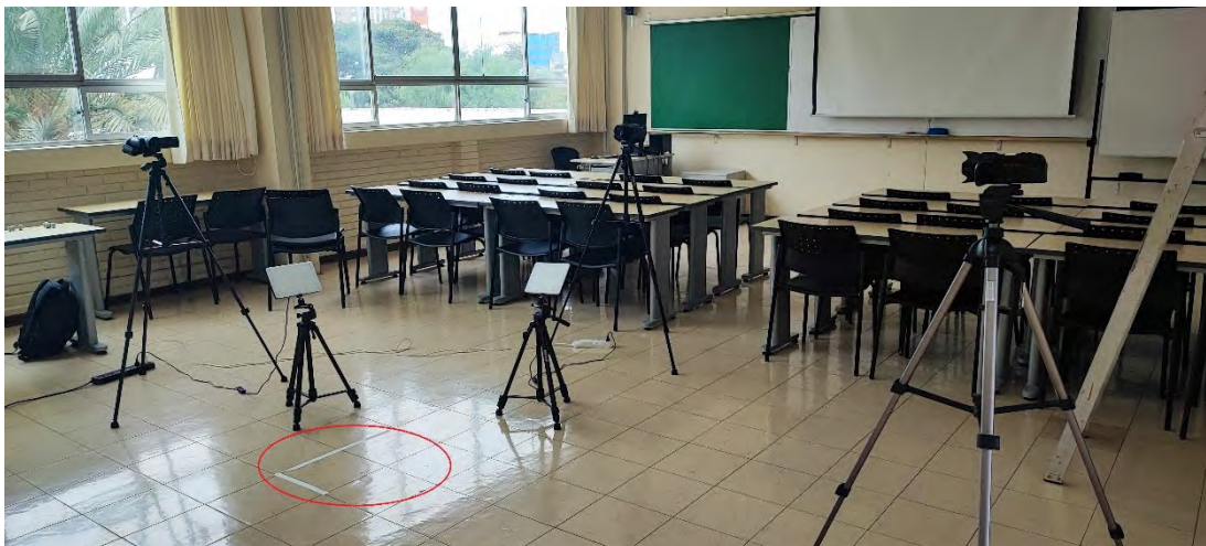
Figura 4.3. Arreglo total de las cámaras utilizado para la grabación del participante. El círculo rojo muestra el área donde se posicionará el participante.
