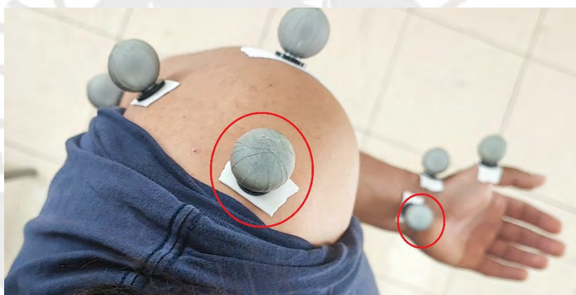
Figura 4.6 Marcadores ubicados en el participante en el plano frontal transversal. Los marcadores específicos del plano se encuentran dentro de los círculos rojos.
