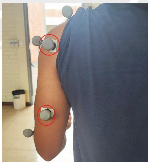
Figura 4.4 Marcadores ubicados en el participante en el plano frontal reverso. Los marcadores específicos del plano se encuentran dentro de los círculos rojos.
