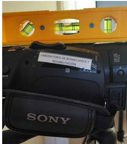
Figura 4.1 Alineamiento de las cámaras utilizando un nivel con el objetivo de tener la lente perpendicular al plano que se desea grabar.
