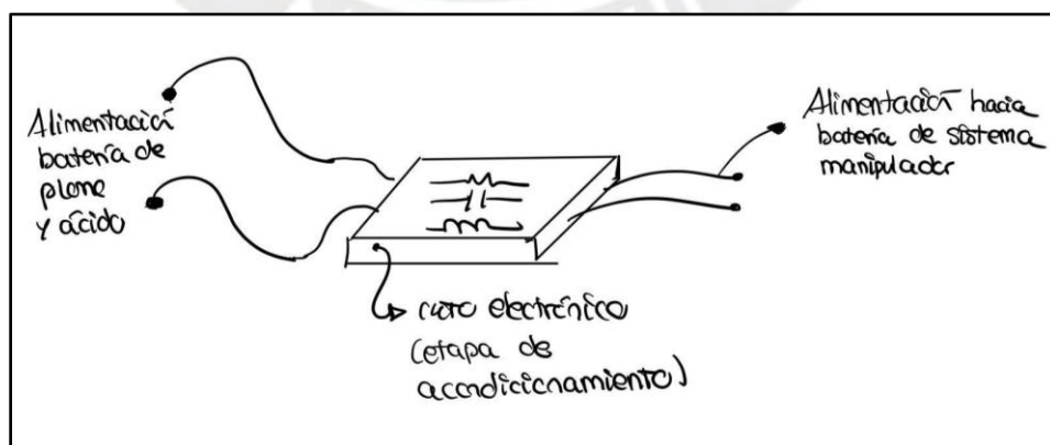
Figura C.21. Vista detallada de la parte electrónica del subsistema estación de carga - Concepto de solución 3. Elaboración propia.
