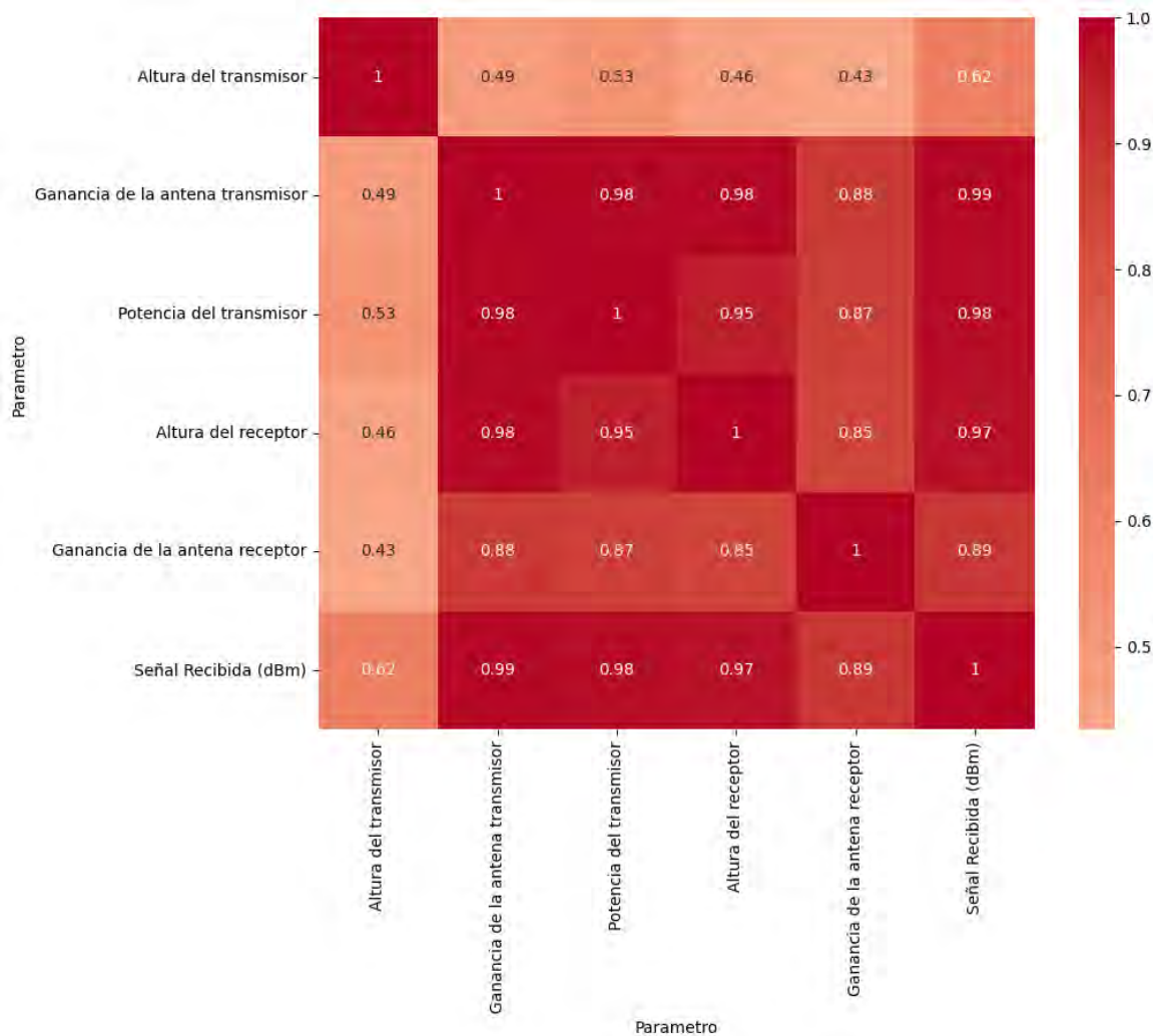
Figura 3.20: Correlación entre los factores de las simulaciones y la señal recibida en el Gateway LPWAN bajo el modelo Cost231-Hata.
