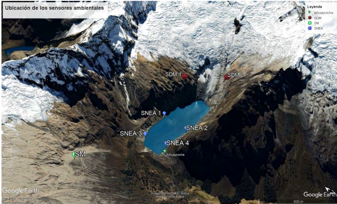
Figura 3.12: Ubicación de los sensores ambientales. Sensor de Nivel de Espejo de Agua (SNEA), Sensor de Deslizamiento de Masas (SDM) y los Sensores Meteorológicos (SM).
