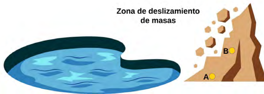
Figura 3.10: Los puntos A y B representan la ubicación del sensor de cuerda vibrante, los cuales se encuentran próximos a la zona de deslizamiento de masas.
