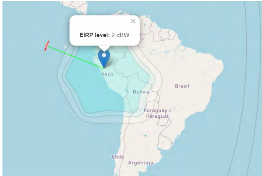
Figura 3.33: Cobertura satelital de Inmarsat I-4 F3 sobre la posición geográfica del Perú. Fuente: satbeams.com
