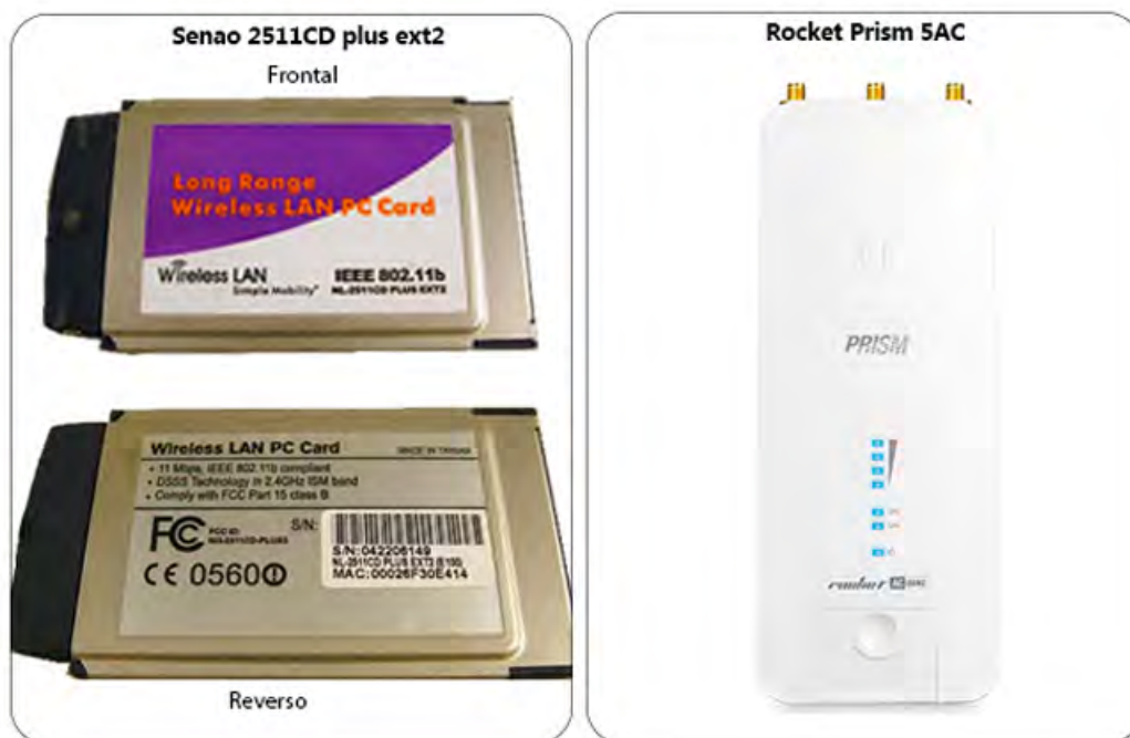
Figura 2.12: Radio Senao 2511CD Plus Ext2 utilizado en el estudio de Chebroly (2006), que permitió un alcance punto a punto de hasta 39 km con velocidades de transferencia de 1-5 Mbps. Por otro lado, el Radio Rocket Prism 5AC, según el informe de Alvarado-Lugo (2018), logró velocidades de aproximadamente 190 Mbps.
