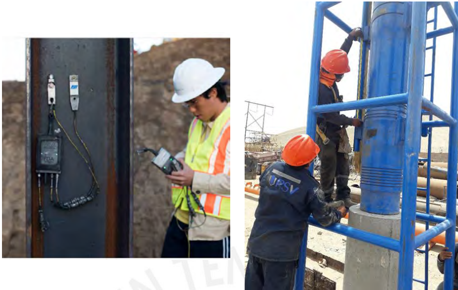
Figura 15. a) Izq. Calibración de equipos. (Pile Dynamics, Inc, 2019b) y b) Acondicionamiento de equipos para prueba de carga PDA.
