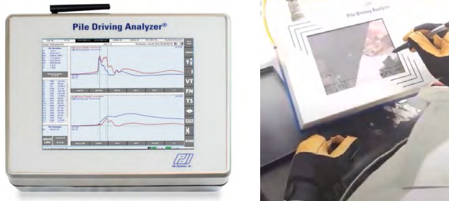
Figura 14. a) Izq. Pile driver analyzer. y b) Der. Uso del Pile driver analyzer en campo.
