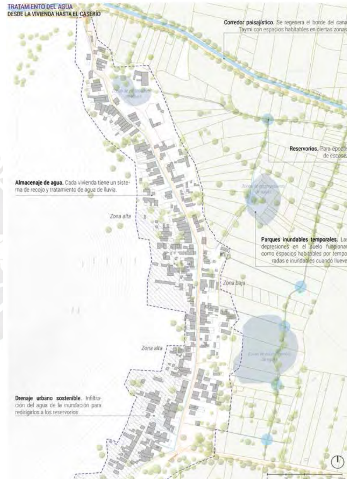
LA RAYA: Conviviendo con la huaca Asentamiento rural productivo resiliente. Rehabilitación urbana del caserío La Raya, Túcume, Lambayeque
