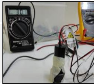
Figura 3.16 Experimento para determinar las características eléctricas del diodo.
