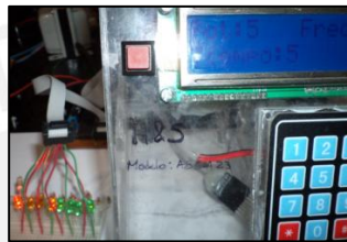
Figura 4.9 La combinación de bits en LEDs (encendido, '1', y apagado, '0')
