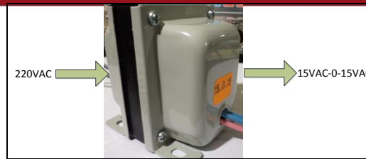
Figura 4.2 Transformador reductor de 15-0-15 Vac de 2 Amperios, es parte del módulo de “fuente de alimentación eléctrica”.
