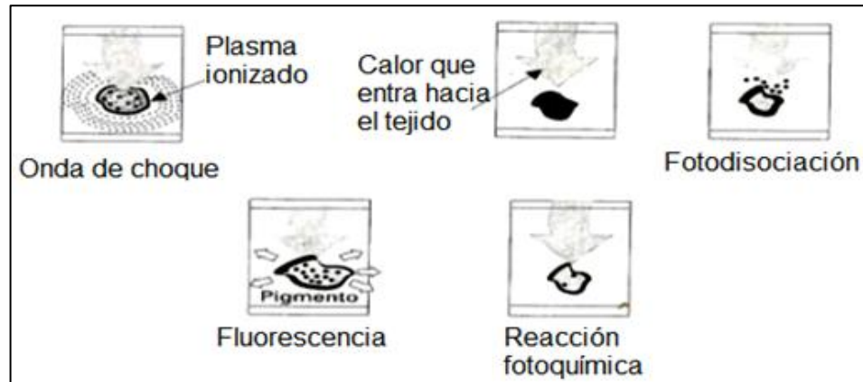
Figura 2.4 Efectos térmicos y no térmicos del láser en los tejidos. Adaptado de [26].
