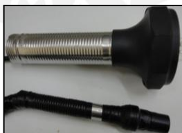
Figura 4.23 Accesorio aplicador de la matriz de LEDs y del diodo láser.
