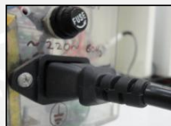
Figura 4.21 Clavija de alimentación con contacto a tierra de protección con cable de alimentación desmontable.
