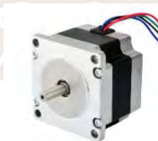
Figura 24: Motor de paso Nema 23 Bipolar 1.8 deg 0.6 Nm 0.88A
