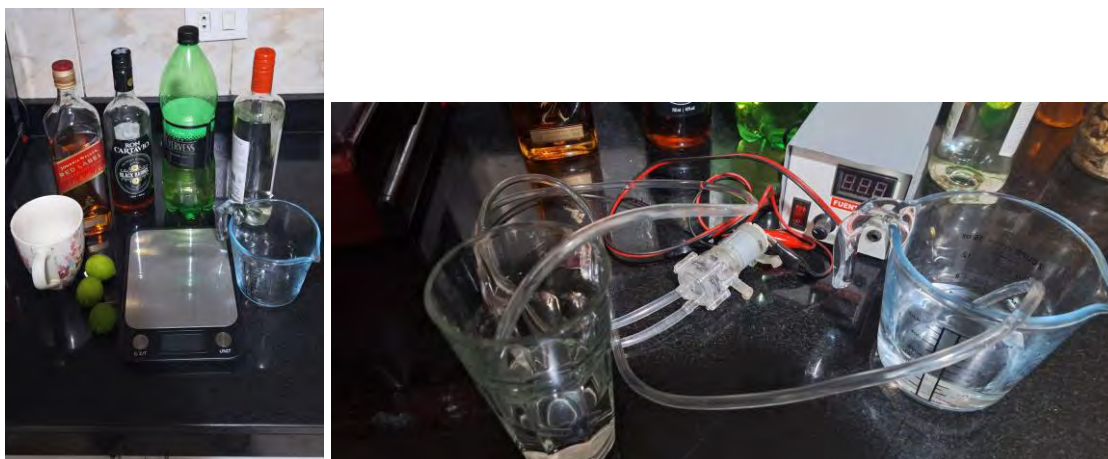
Figura 63: Armado del experimento para el cálculo de densidad y caudal real de transporte Fuente: Elaboración propia
