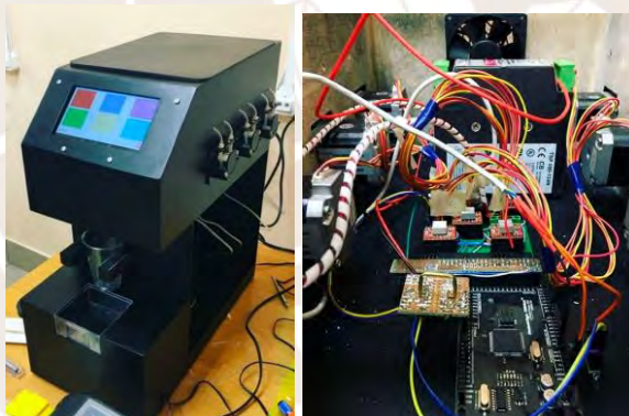
Figura 11: Imagen del exterior e interior del Smart Bartender with Peristaltic Pumps
