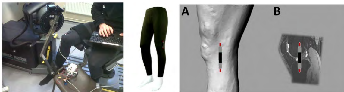
Figura 1.18 - Sensores de ropa adherible para medir ángulos de la articulación de la rodilla (Bergmann, 2013)
