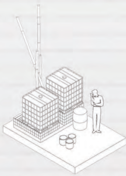
Cimiento - almacén de agua
