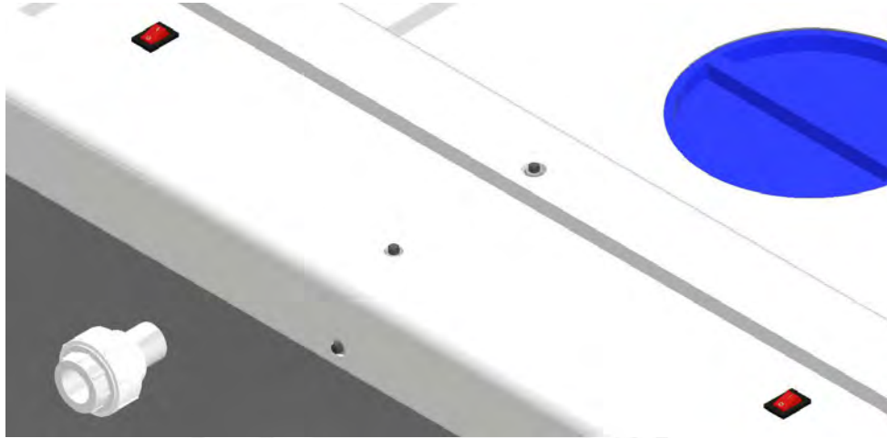
Figura 4.14. Switches de encendido y apagado del sistema. Fuente propia
