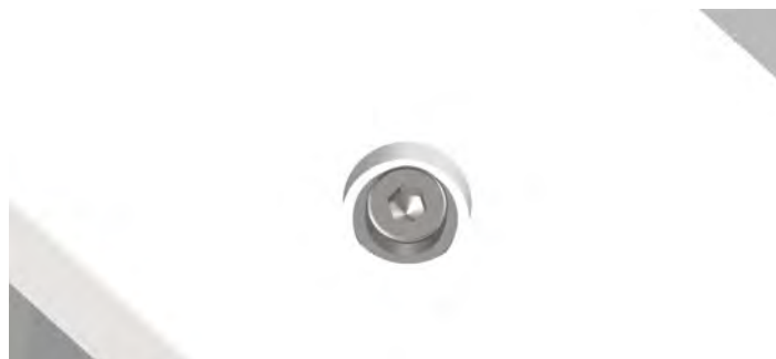
Figura 4.10. Unión de marcos de fibra de vidrio y planchas de aluminio a la estructura. Fuente propia.
