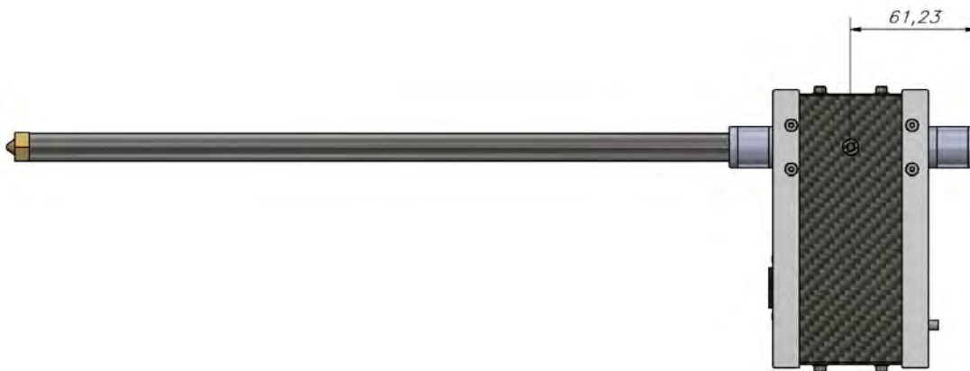
Figura 2.6. Distancia de la manguera al eje del servomotor. Fuente propia.
