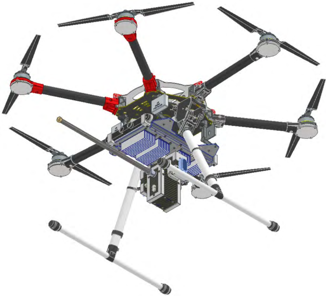
Figura 2.14. Vista inferior del módulo y dron acoplados. Fuente propia.
