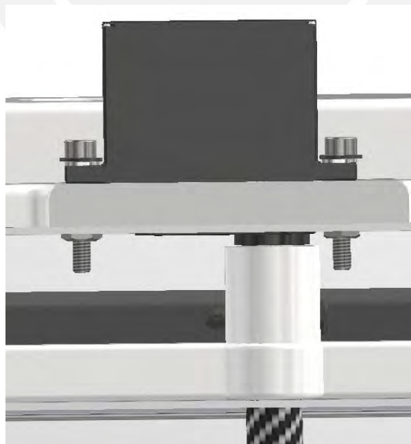
Figura 2.7. Servomotor encargado del movimiento en un plano horizontal. Fuente propia.
