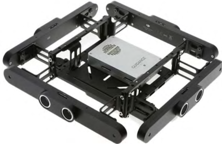
Figura 2.5. Sistema de detección Guidance. Fuente DJI.
