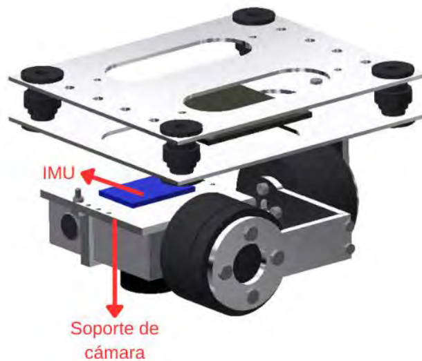
Figura 3.16 integración IMU y soporte de cámara
