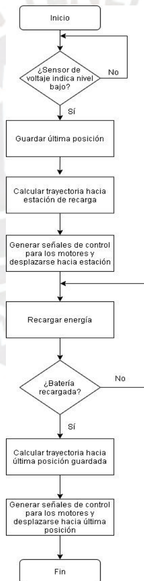
Figura 4.44: Diagrama de flujo de proceso de recarga de batería
