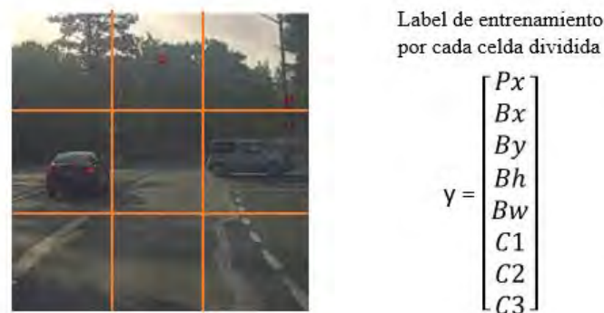
Figura 2.15: Etiquetas para entrenar una CNN de detección de objetos 9
