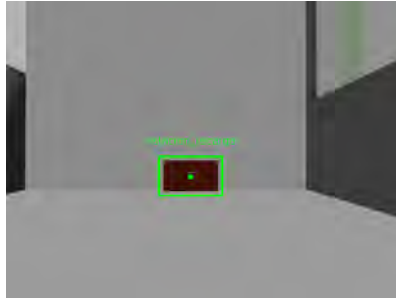
Figura 5.17: Estación de recarga identificada por la red neuronal convolucional
