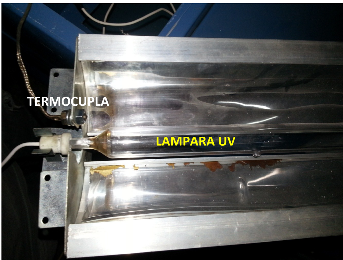
Fig. 1. Ubicación de la termocupla en el túnel de curado uv.
