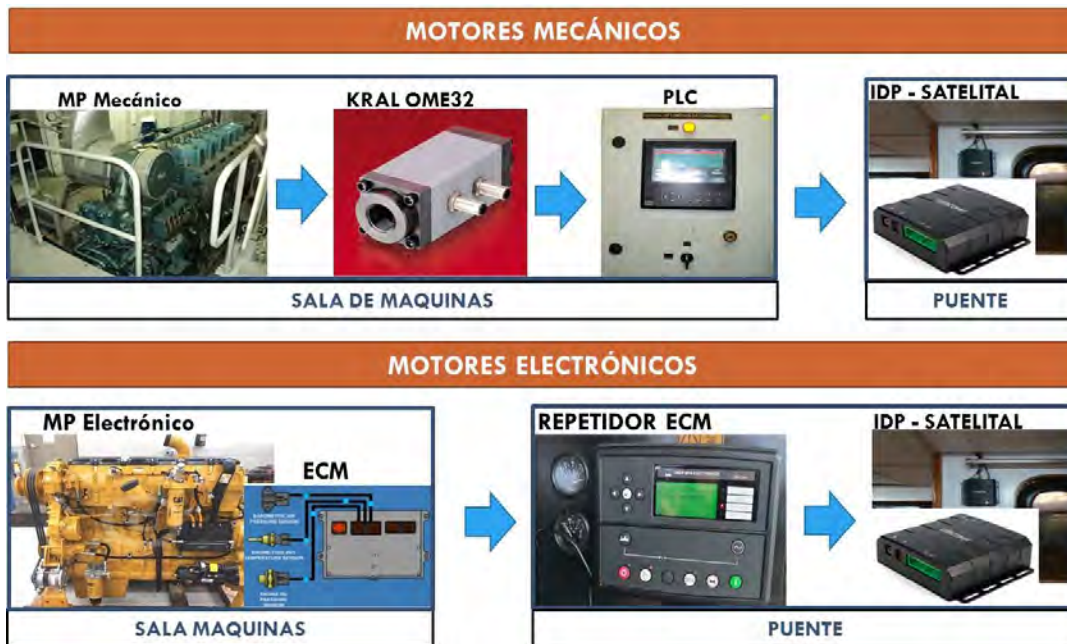
Figura 17. Equipos de control de combustible por tipo de motor
