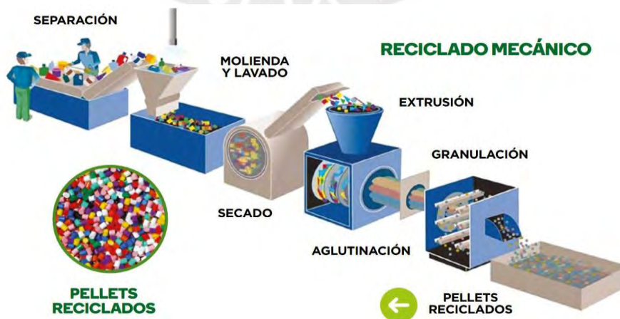
Figura 5. Esquema del reciclado mecánico de plásticos (Castaño, 2024)
