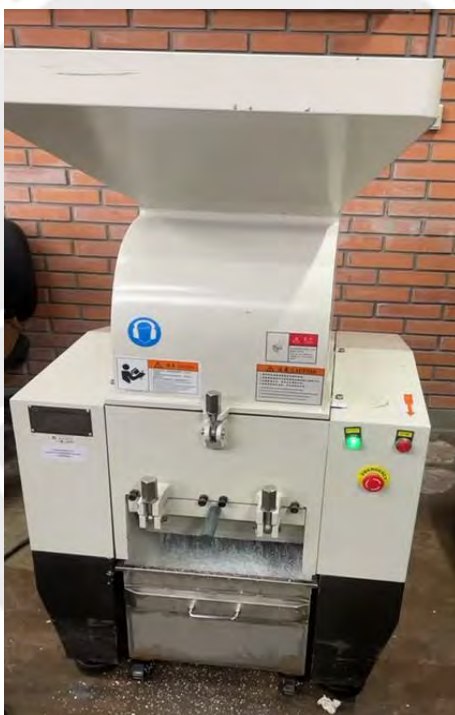
Figura 11. Equipo de trituración de material (Fuente: Propia)
