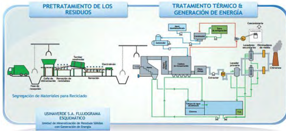
Figura 4. Esquema del reciclado energético del plástico (Ecoplas, 2017)
