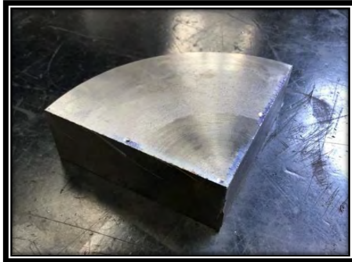
Figura 2. 17. Probeta para el ensayo de dureza Vickers
