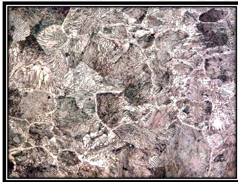
Figura 1. 9. Microestructura de aceros hipereutectoides
