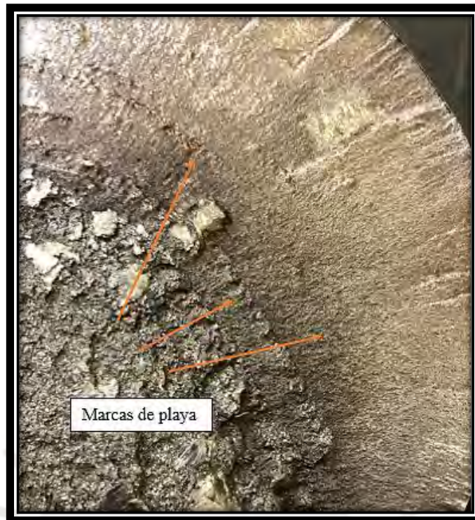
Figura 3. 8. Presencia de marcas de playa en la zona de fractura
