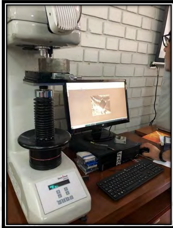
Figura 2. 23. Durómetro Zwick/Roell Indenter ZHV
