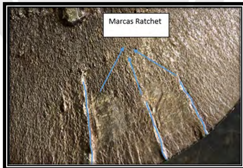
Figura 3. 7. Presencia de marcas "Ratchet" en la superficie fracturada del eje
