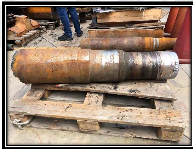
Figura 2. 31. Parte larga del eje fracturado
