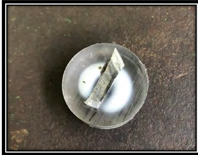
Figura 2. 41. Probeta para el análisis metalográfico
