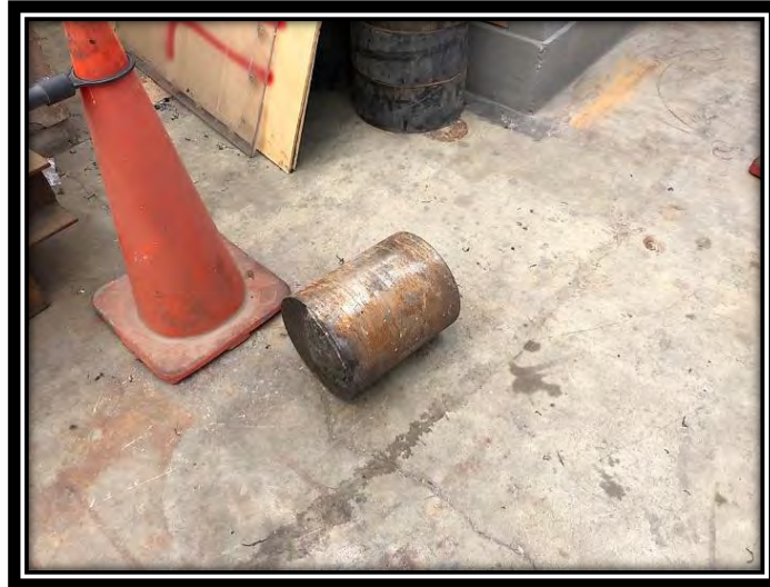
Figura 2. 32. Parte corta del eje fracturado
