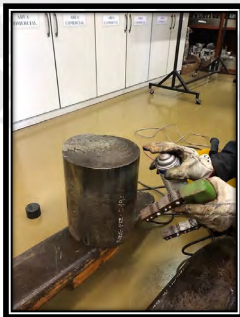
Figura 2. 35. Aplicación del líquido con partículas magnéticas
