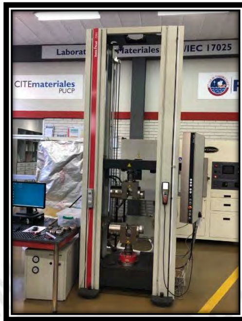
Figura 2. 6. Máquina de ensayo para tracción electromecánica Zwick/Roell modelo Z250
