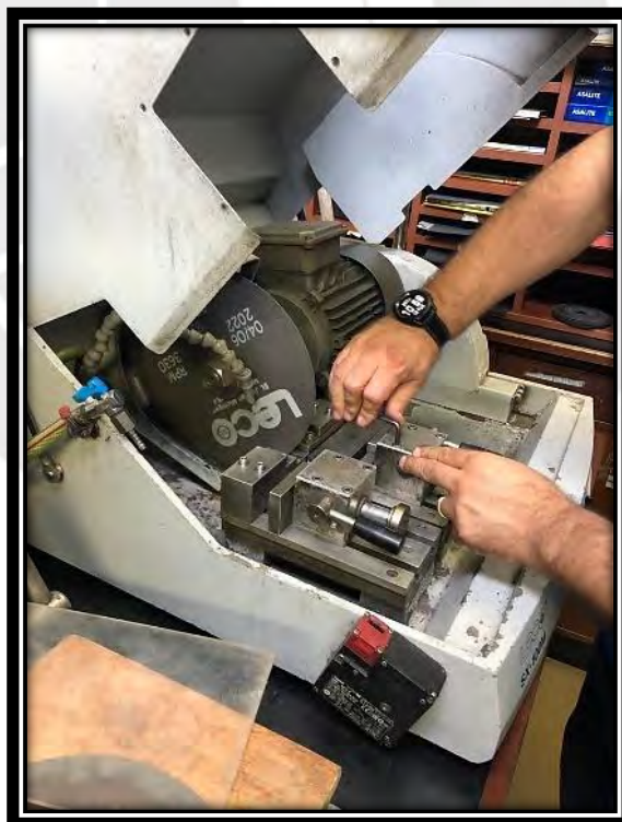
Figura 2. 24. Cortadora de mesa LECO SX-100M
