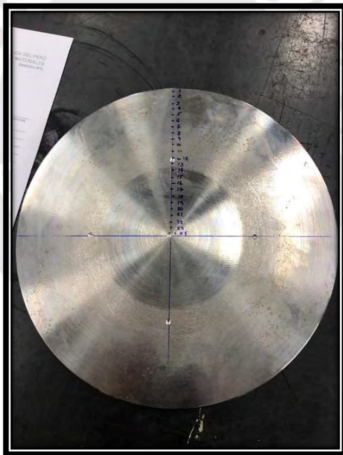
Figura 2. 16. Probeta para el ensayo de dureza Brinell
