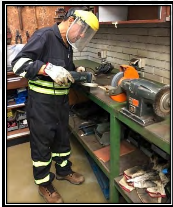
Figura 2. 19. Desbaste de la superficie de la probeta para el ensayo de dureza
