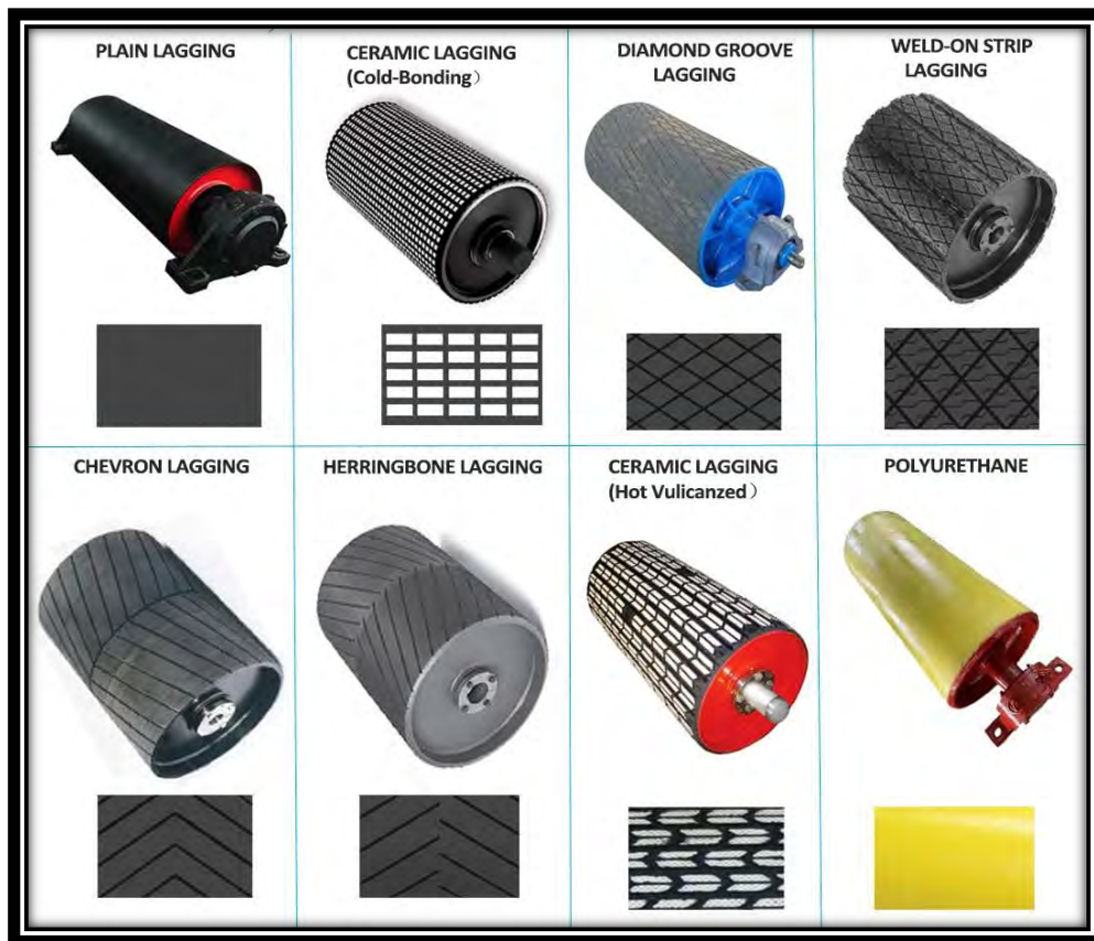
Figura 1. 5. Tipos de poleas para fajas transportadoras
