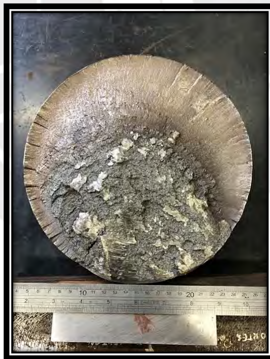
Figura 2. 38. Superficie de fractura del eje
