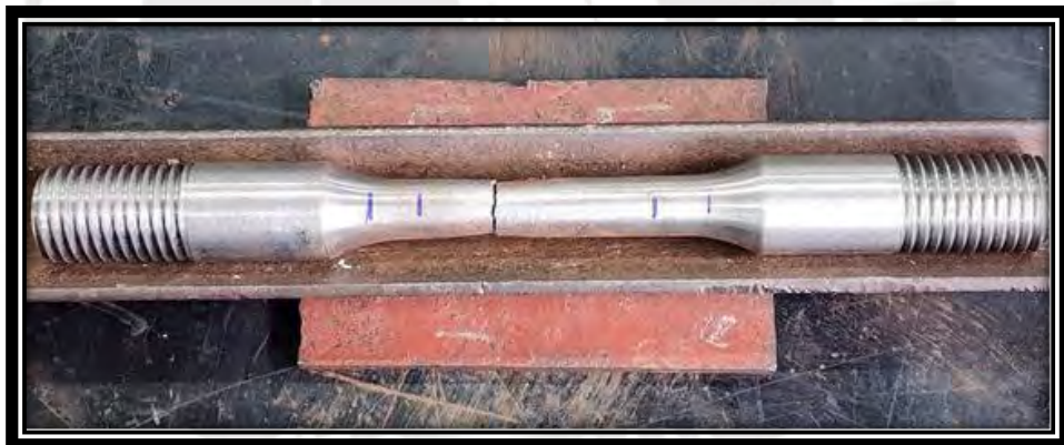
Figura 2. 7. Probeta fracturada del ensayo de tracción
