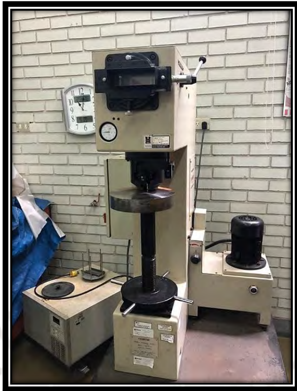
Figura 2. 18. Durómetro Brinell marca Foundrax modelo Brin 200 M
