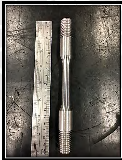
Figura 2. 5. Probeta utilizada para el ensayo de tracción
