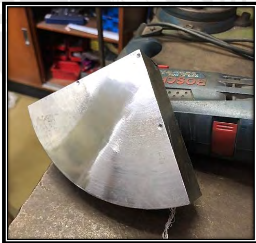
Figura 2. 21. Superficie preparada para el ensayo de dureza
