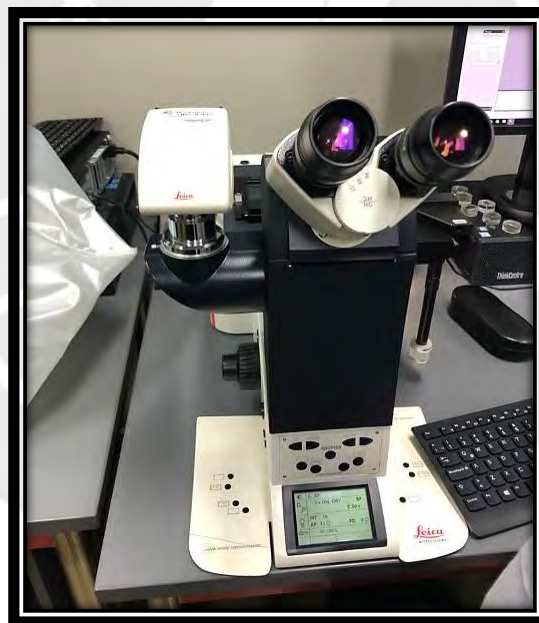
Figura 2. 30. Microscopio digital invertido Leica DMI5000 M
