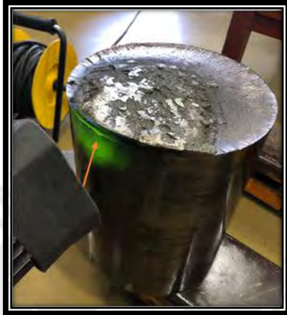
Figura 3. 5. Grieta debida a la fractura del eje
