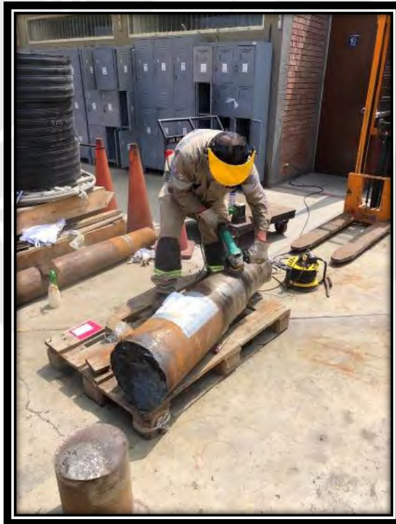
Figura 2. 33. Pulido del eje fracturado
