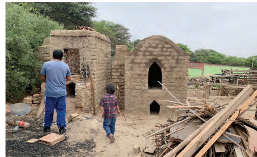
Hornos para cocer cerámica de torno. A la derecha el primer horno familiar y a la izquierda el modelo mejorado piurano
