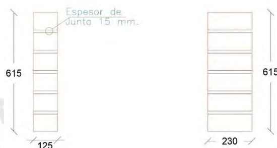
Figura 4.1: Medidas de las pilas expresadas en milímetros
