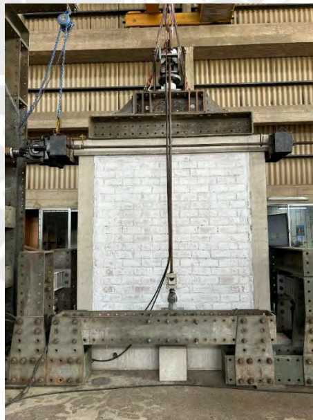
Figura 6.2: Instalación final de las gatas y actuadores hidráulicos para la aplicación de cargas horizontales y verticales previo al ensayo del muro M1-CA
