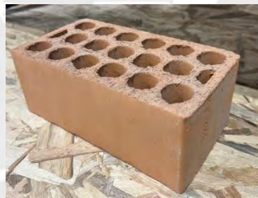
Figura 3.1: Ladrillo de arcilla tipo King Kong de 18 perforaciones
