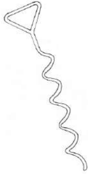
Figura A.9. Detalle de la pieza de anclaje para jardín. Fuente: Elaboración propia.
