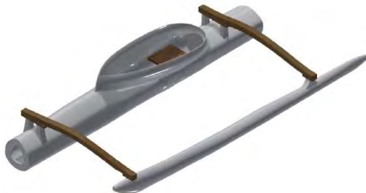
Figura B.3: Diseño de la cabina V1 ensamblada con iakos y ama. Fuente: Elaboración propia.
