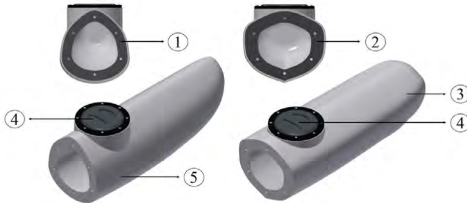
Figura 4.7: Diseño en Autodesk Inventor de los flotadores de la proa y popa 6 . Fuente: Elaboración propia.
