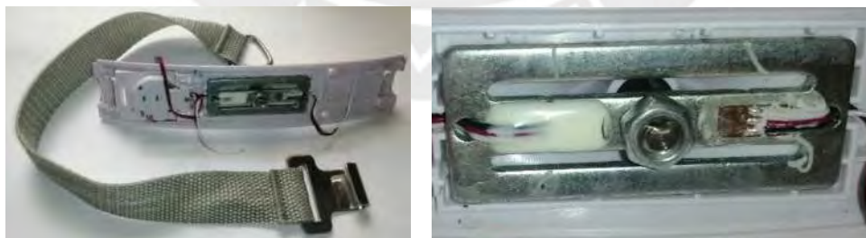
Figura C.1: Detalle de la electrónica interna de la balanza de peso. Fuente: Elaboración propia.
