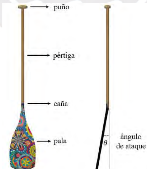
Figura B.1. El remo “ single bend ” y sus partes. Fuente: Elaboración propia.
