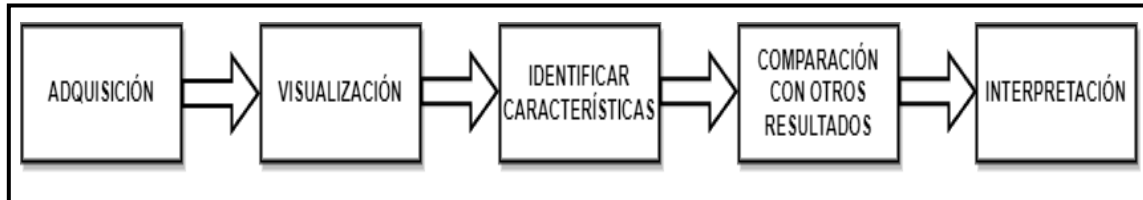
Figura N°28. Proceso de análisis cualitativo a imágenes de Electroluminiscencia
