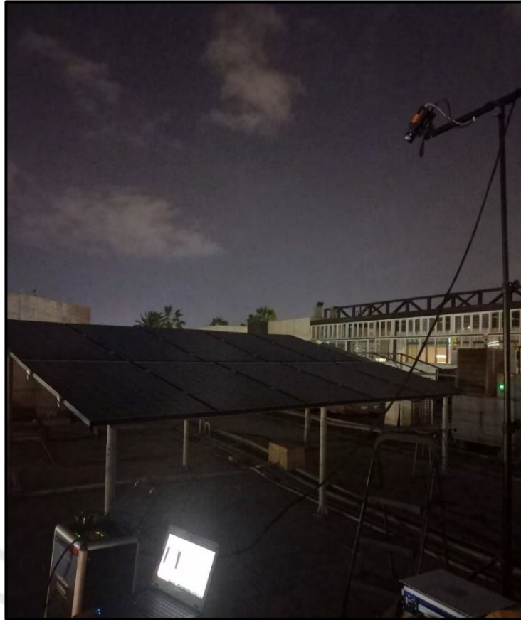
Figura N°38. Montaje experimental del sistema de Electroluminiscencia
