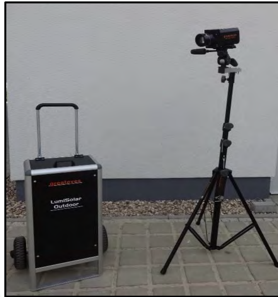
Figura N°32. Sistema de medición de electroluminiscencia [58]
