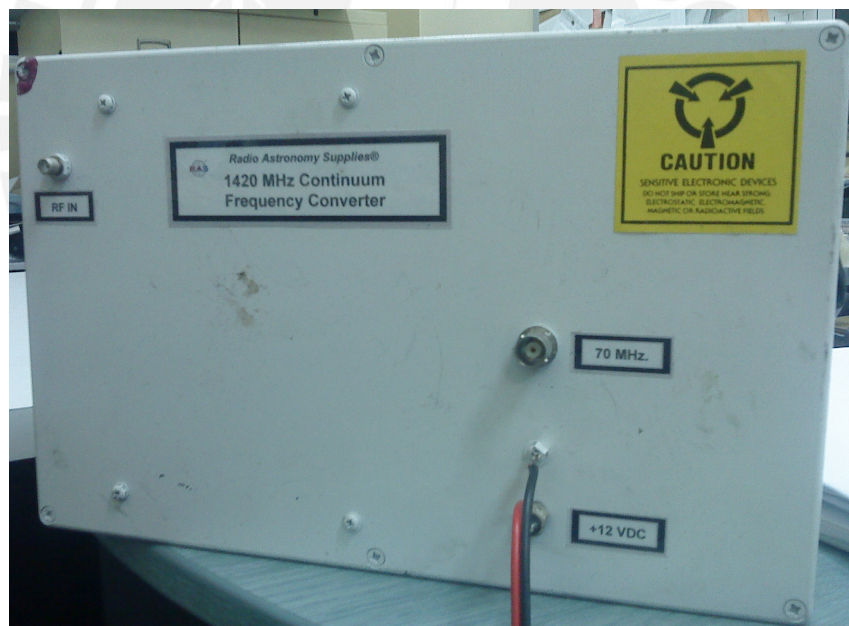
Figura N° 37: Convertidor de frecuencias de en C11. Como entrada se tiene un conector SMA hembra, y como salida un conector BNC hembra.
