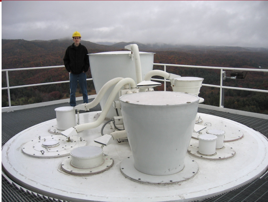
Figura Nº 15: Tambor giratorio con 8 alimentadores (proyecto de la creación de un espectrómetro de banda amplia de frecuencias de la universidad de Maryland, aplicado en el radio telescopio de Green Bank, West Virginia, USA).
