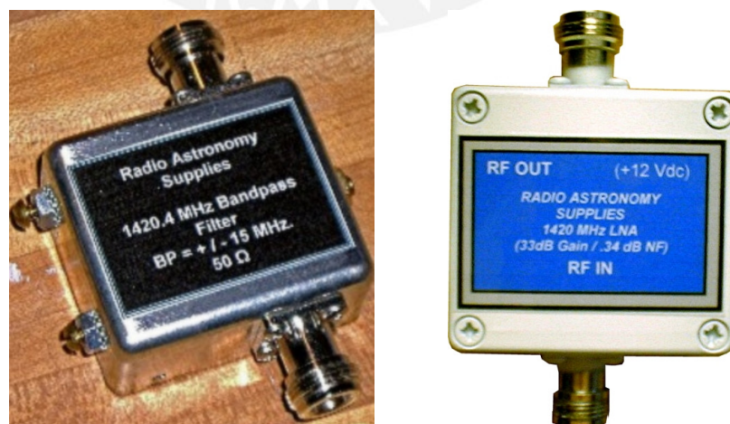
Figura N° 36: Filtro pasa banda y LNA a utilizar, cada uno con conectores N hembra en las entradas y salidas.
