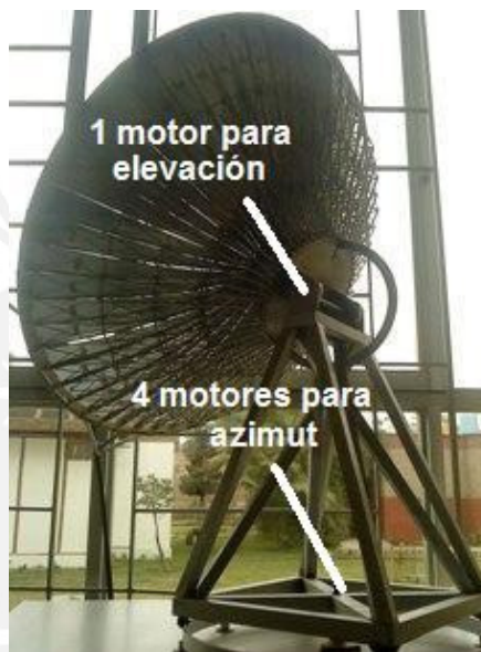
Figura N° 11: Maqueta de la antena ubicada en el Instituto de Radio Astronomía de la PUCP (INRAS), indicando las posiciones de los motores de azimut y elevación.
