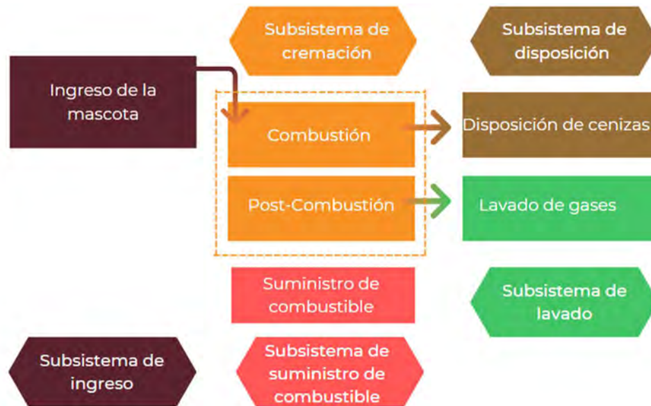
Figura 2.1. Descripción de proceso general del horno crematorio. Fuente Elaboración Propia.
