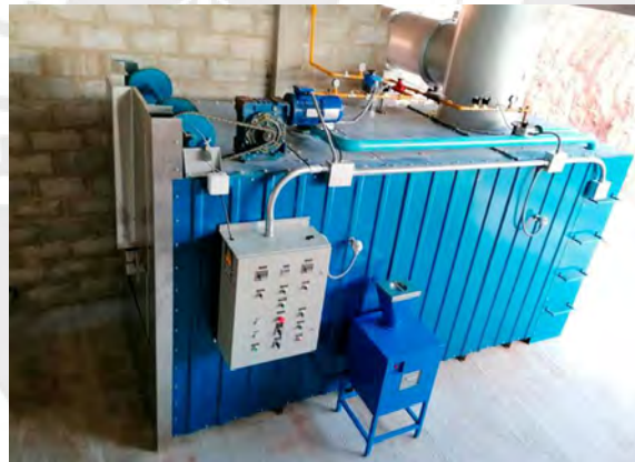
Figura E.1: Vista lateral del horno crematorio de Hornos Félix. Fuente: Hornos Félix
