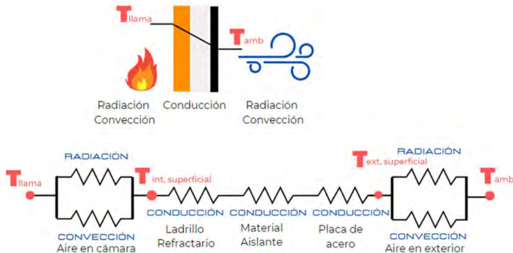
Figura 4.1: Modelo de resistencias para transferencia de calor en la cámara de combustión. Fuente: Elaboración propia, con elementos gráficos de Canva
