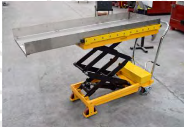
Figura E.11: Vista de la mesa hidráulica en posición alta. Fuente: Addfield
