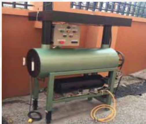
Figura 9: Máquina híbrida para secado de granos de cacao
