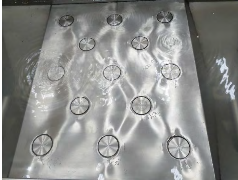
Figura 78. Prueba de funcionamiento de los transductores de ultrasonido.
