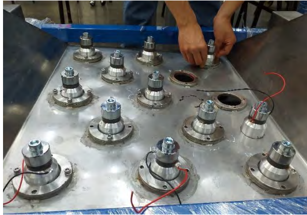
Figura 31. Instalación de los actuadores de ultrasonido sobre la base de la tina de lavado
