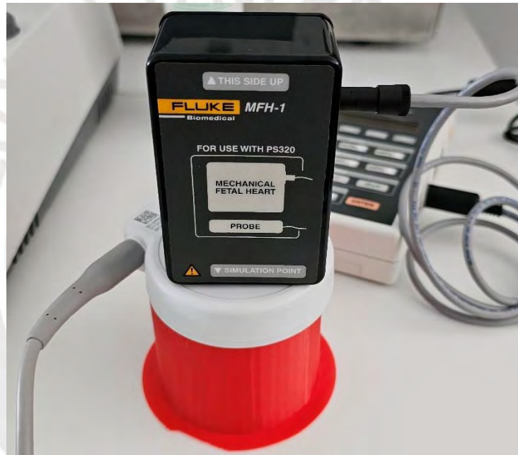
Figura 2.8. Acople del Transductor de US del equipo bajo pruebas al MFH-1 del equipo patrón Fluke PS320
