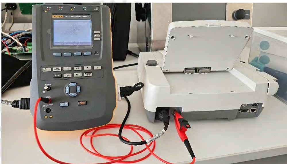
Figura 2.6. Conexiones del equipo bajo pruebas al equipo patrón para los ensayos de tensión de red, resistencia de tierra de protección y corriente de fuga a tierra.
