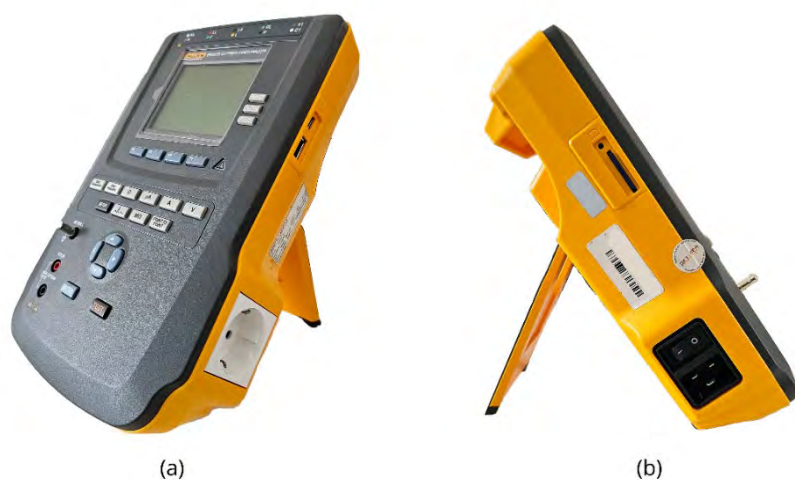
Figura 2.3. Equipo para pruebas de seguridad eléctrica. (a) Vista anterolateral izquierdo, (b) Vista lateral derecha. [Elaboración propia]
