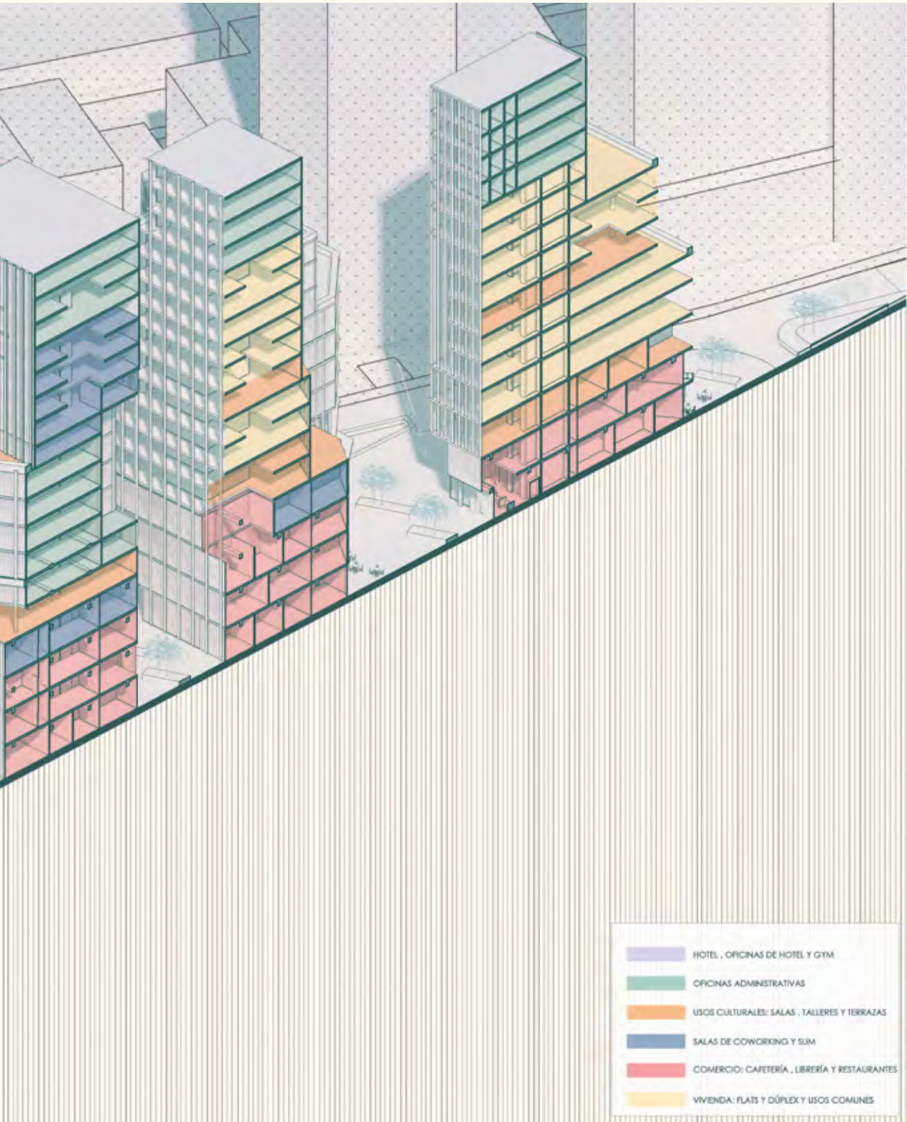
Figura 66_ Corte fugado programático del Conjunto Vertical Limatambo Fuente propia.
