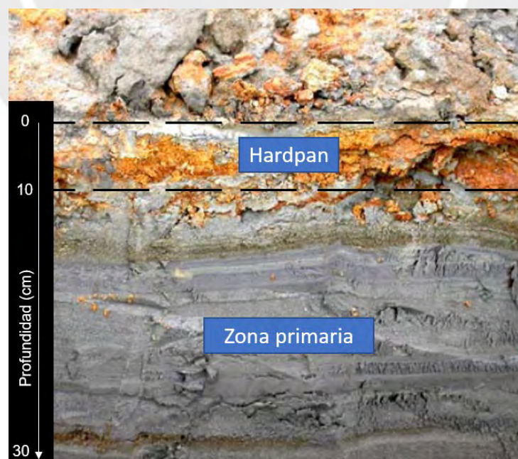
Fig. 1.9: Zona cementada también reconocida como hardpan en el Embalse de Relaves Quiulacocha (objeto de estudio) (modificado de Wade, 2005).
