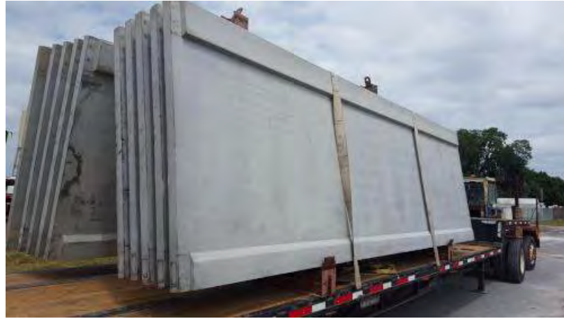
Imagen 57: Elementos planos fabricados con Sistema en Bateria Ratec
