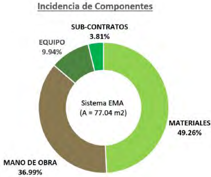
Gráfico 19: Incidencia de Mano de Obra – Encofrado de Aluminio (A=77.04 m2)
