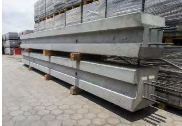
Imagen 32: Columnas prefabricadas de concreto
