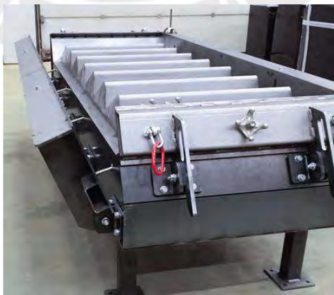
Imagen 70: Encofrado de escalera
