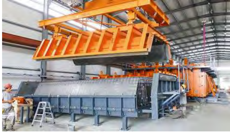
Imagen 71: Encofrado y acero de refuerzo en techo de vivienda modular
