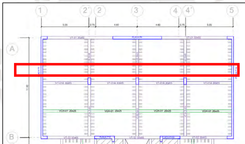
Figura 6 Vigueta seleccionada para el ejemplo de diseño Nota. Fuente propia.
