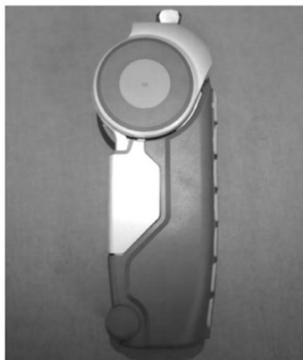
Fig. 2.6 Prótesis con control electrónico rodilla 3E80 Ottobock [Ortiz, 2022].
