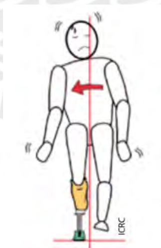
Fig. 1.48 Inclinación lateral del tronco en el lado de la prótesis transtibial [ICRC, 2014].
