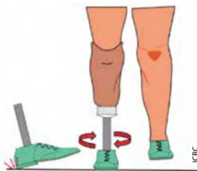
Fig. 1.47 Desplazamiento excesivo posterior [ICRC, 2014].
