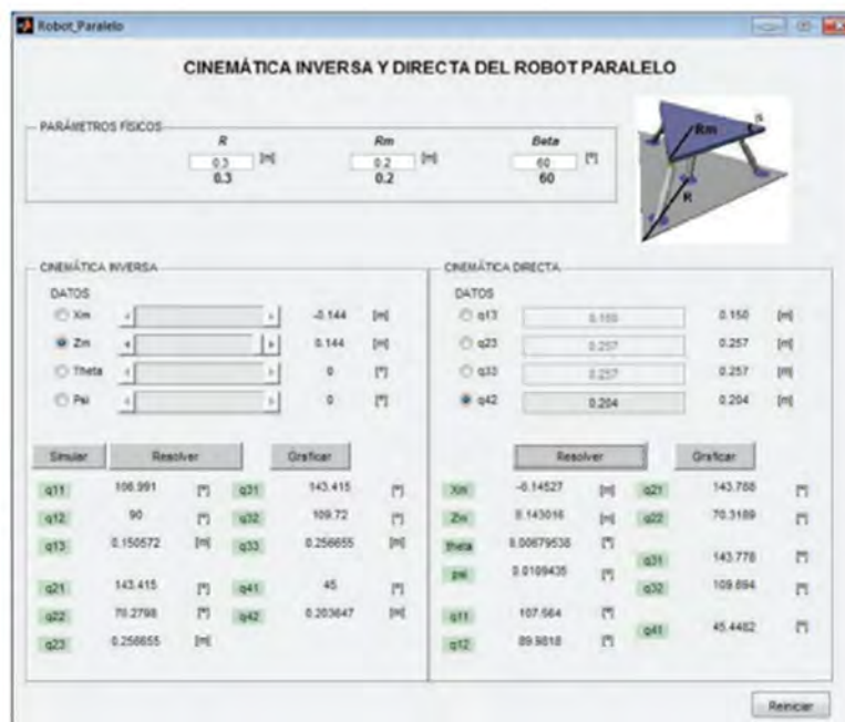
Fig. 2.23. GUIDE: interfaz gráfica de usuario del mecanismo paralelo [Fernández, 2016].
