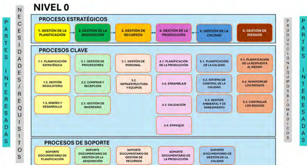
Figura 7. Nivel 0 del mapa de procesos de la producción de equipos biomédicos [Elaboración propia]
