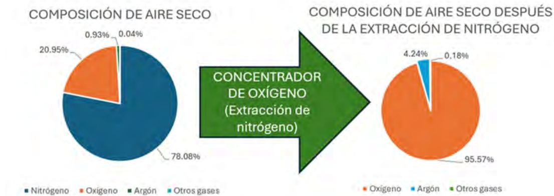
Figura 2. Composición del aire antes y después de la extracción del nitrógeno [Elaboración propia] Adsorción por Presión Oscilante (PSA)
