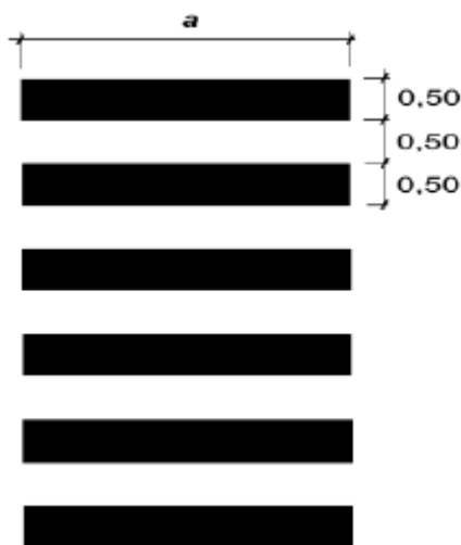
Figura 4. Señal horizontal de paso para peatones M-4.3
