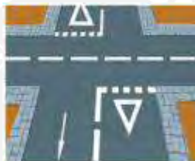
Figura 1. Señal horizontal de ceda el paso
