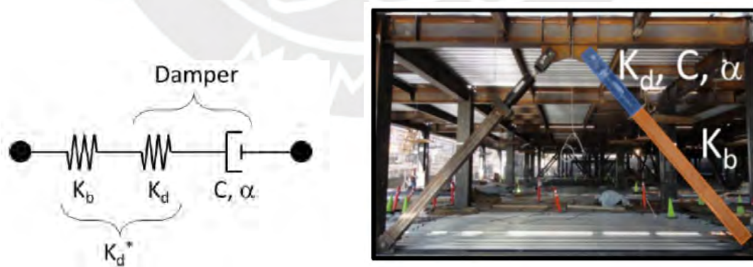
Figura 36: Configuración en serie del amortiguador. (Taylor devices inc., 2019)
