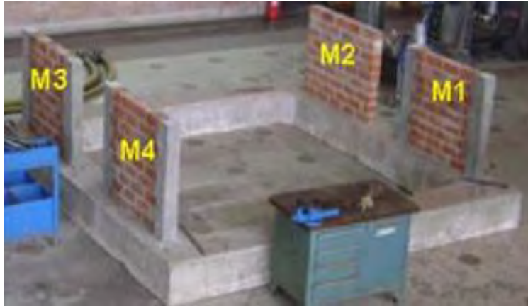
Figura 22. Parapetos construidos sobre un anillo de concreto (Fuente: Siancas y Manrique)
