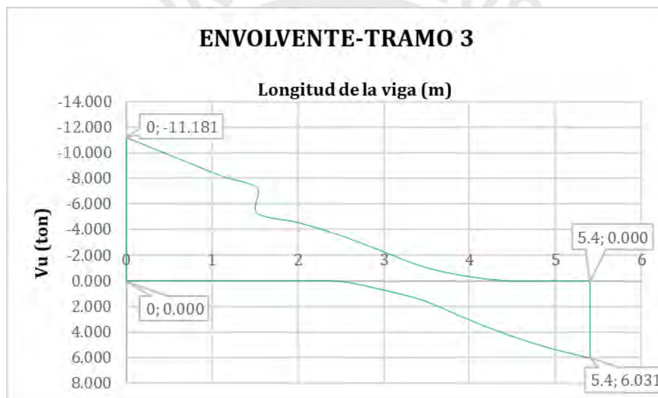
Figura 53. Envolvente de cortante último del tercer tramo
