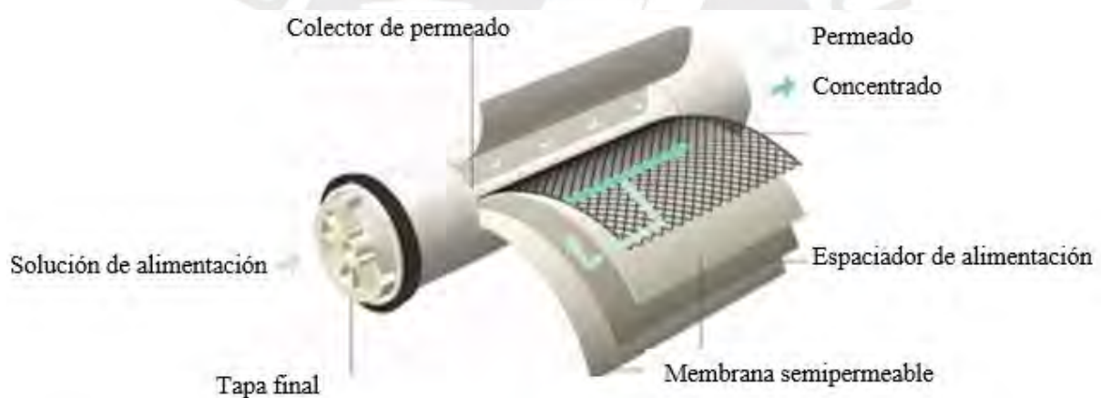
Figura 2.2. Estructura del módulo de arrollamiento en espiral.
