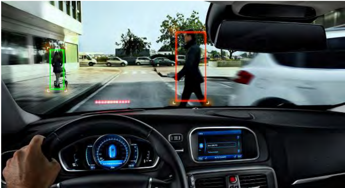
Figura 4:Medida de seguridad activa: sistema de detección de peatones
