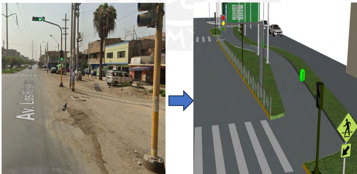
Figura 79: Valla de acero instalada en las proximidades del cruce peatonal y camino sinuoso
