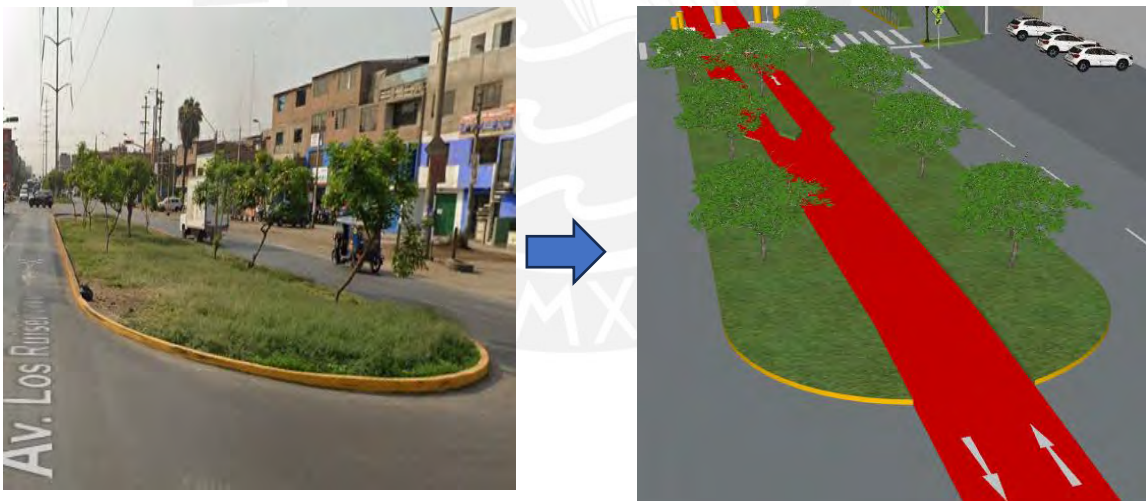
Figura 72: Propuesta de ciclovía para las medianas de 9 metros de ancho con árboles a los costados
