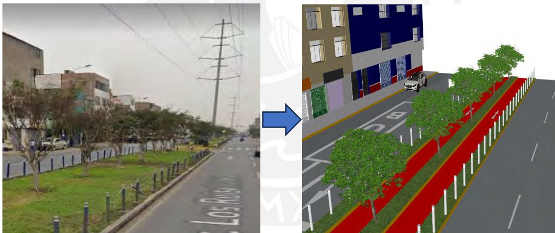
Figura 70:Propuesta de ciclovía para las medianas de 5.8metros de ancho con árboles al centro
