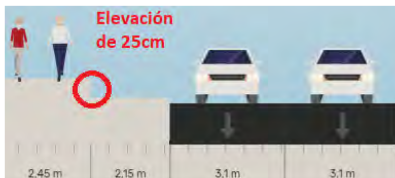
Figura 61: Propuesta de eliminación de rampa
