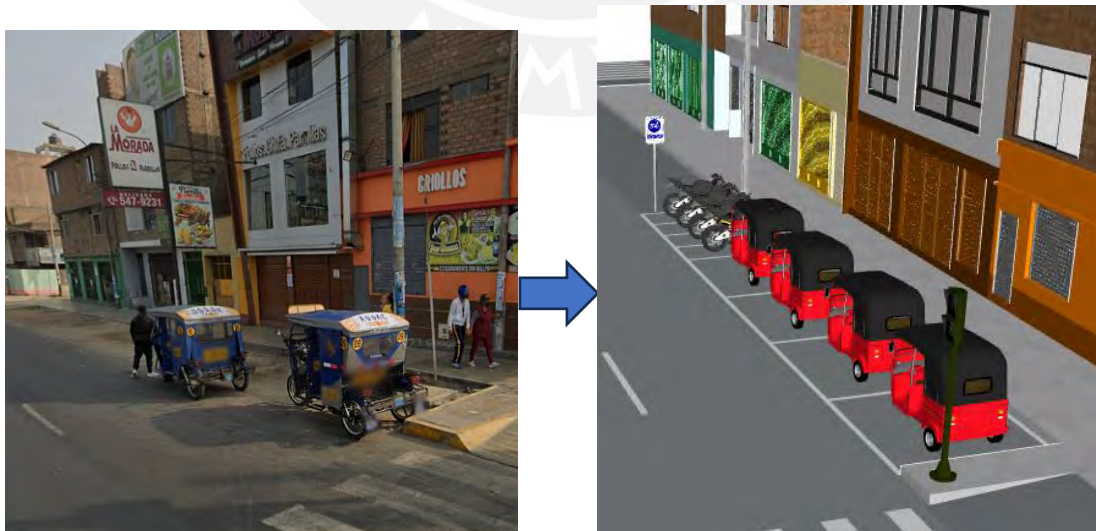
Figura 66: Propuesta de formalización de estacionamiento para mototaxis y motocicletas en 3D
