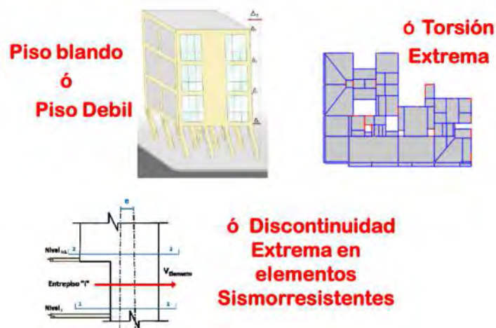
Figura 5 Irregularidad estructural para un edificio aislado. Fuente: A. Muñoz, 2020
