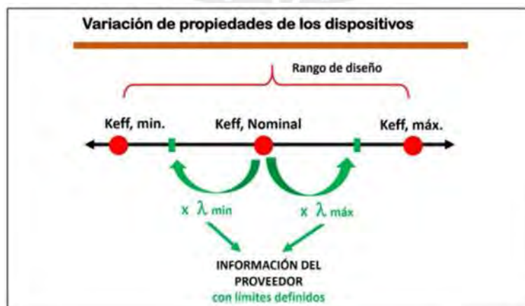
Figura 15 Esquema de propiedades de un aislador. Fuente: Norma E-031, 2019
