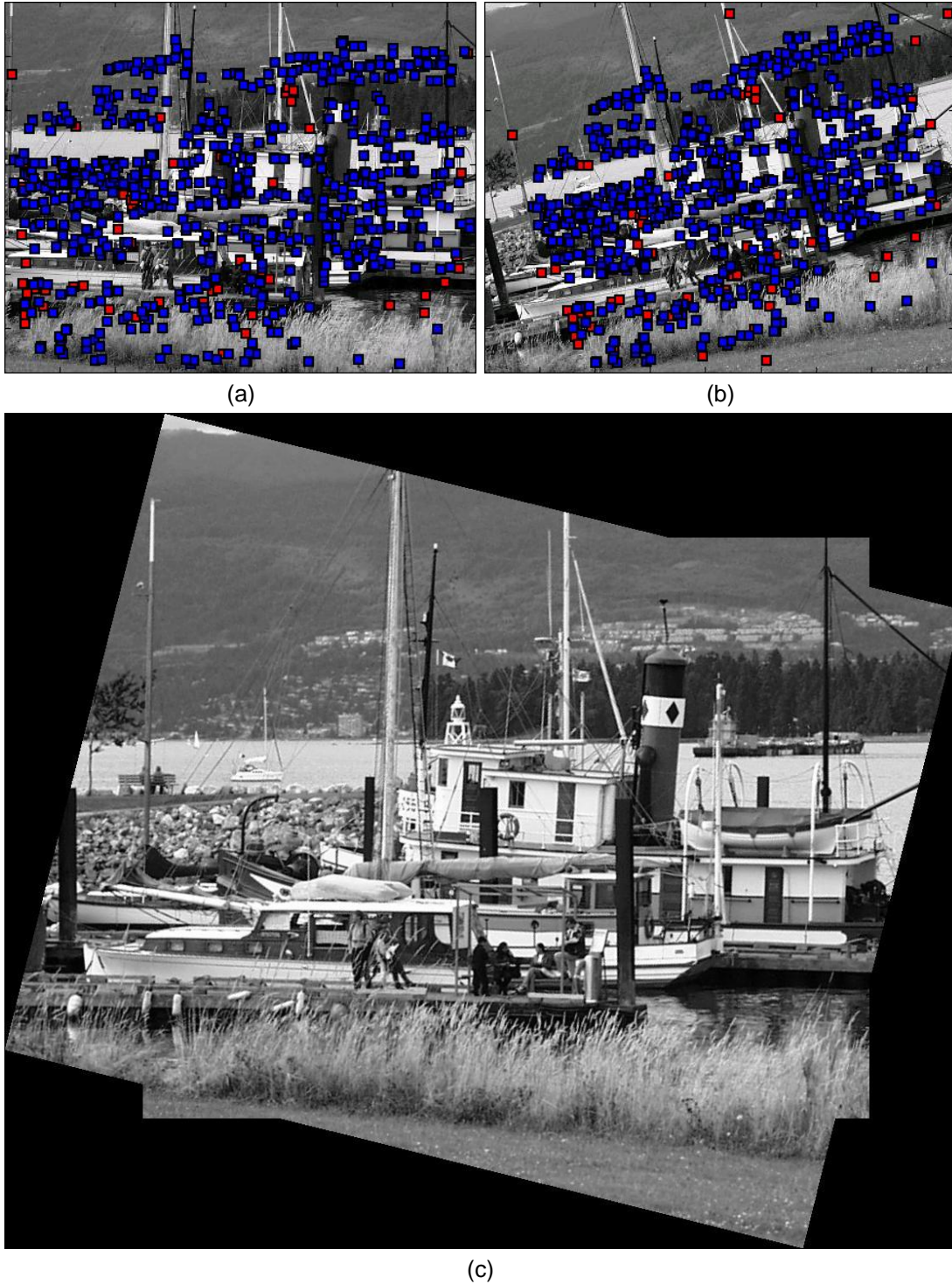
Figura 2. Mosaico a partir de imágenes 1 y 2. (a) Puntos de correspondencia en imagen 1. (azul) puntos incluidos en la función estimada. (rojo) puntos no incluidos en la función estimada. (b) Puntos de correspondencia en imagen 2. (azul) puntos incluidos en la función estimada. (rojo) puntos no incluidos en la función estimada. (c) Mosaico desarrollado.
