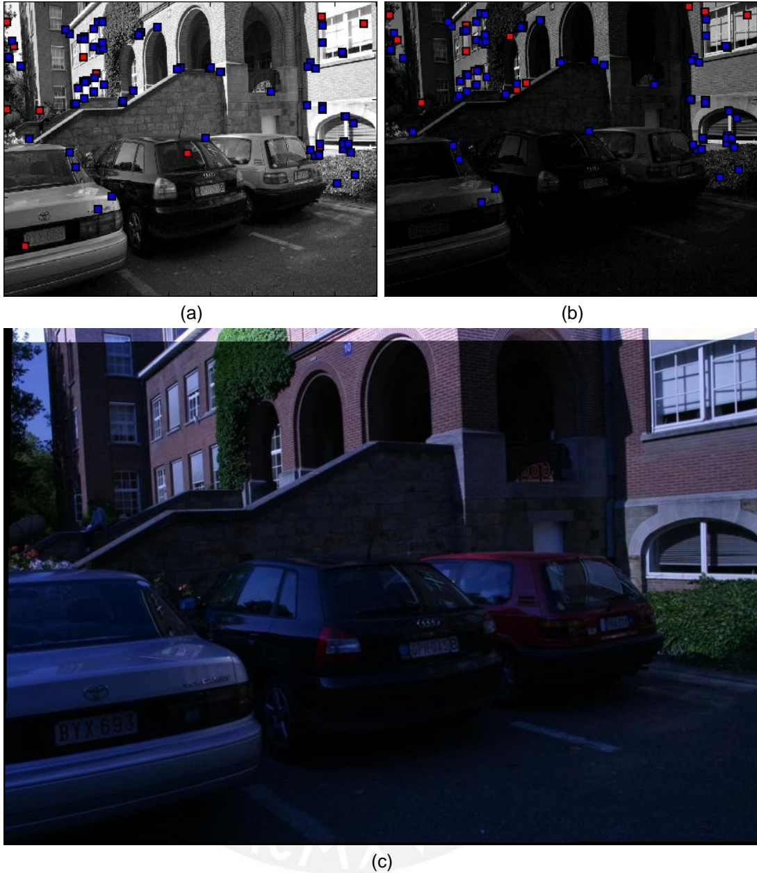
Figura 40. Mosaico a partir de imágenes 1 y 6. (a) Puntos de correspondencia en imagen 1. (azul) puntos incluidos en la función estimada. (rojo) puntos no incluidos en la función estimada. (b) Puntos de correspondencia en imagen 6. (azul) puntos incluidos en la función estimada. (rojo) puntos no incluidos en la función estimada. (c) Mosaico desarrollado.
