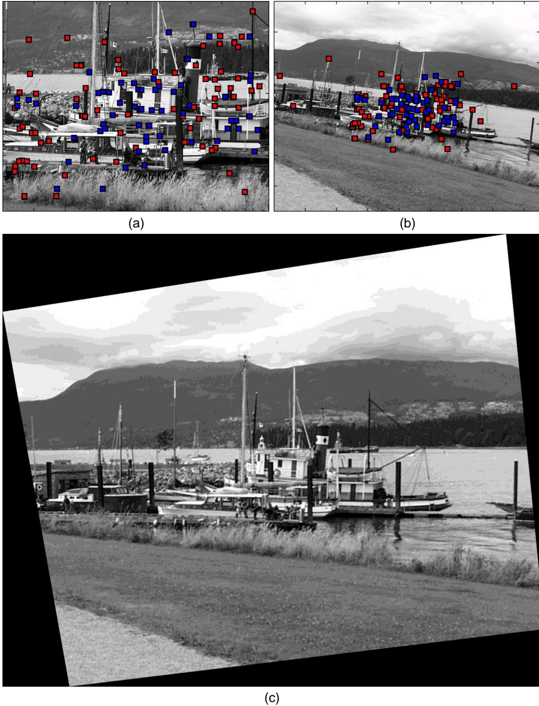
Figura 5. Mosaico a partir de imágenes 1 y 5. (a) Puntos de correspondencia en imagen 1. (azul) puntos incluidos en la función estimada. (rojo) puntos no incluidos en la función estimada. (b) Puntos de correspondencia en imagen 5. (azul) puntos incluidos en la función estimada. (rojo) puntos no incluidos en la función estimada. (c) Mosaico desarrollado.
