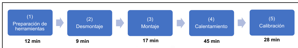
Figura 19. Actividades y tiempo de cambio de matriz en la máquina sopladora N° 3 Fuente. Elaboración propia
