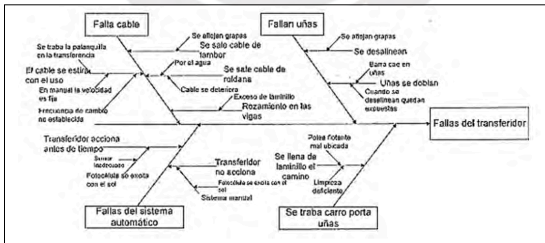
Figura 4. Ejemplo de Diagrama de Ishikawa. Análisis de la falla del transferidor Fuente. Díaz, Bonilla, Kleeberg, & Noriega (2010)
